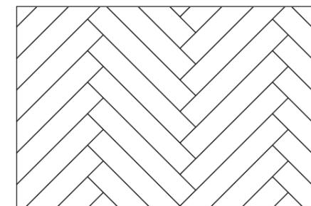
フローリングを山型に張っていく方法。ニシンの背骨の形に似ていることからヘリンボーンと呼ばれます。木口を合わせて直線的に張るとフレンチヘリンボーン張りになります。
