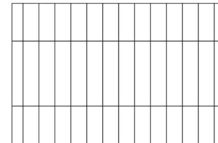
同じ長さのフローリングを巾方向の接合面を揃えて張る方法。天井の張り方によく見られます。
