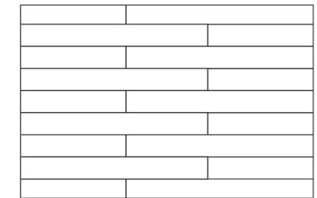
同じ寸法のフローリングを一定の間隔でずらして張る方法。ずらす寸法によって雰囲気が変わりますが、木目のつなぎ目が直線上に合わさると整然とした印象に仕上がります。りゃんこは2個(両個)の意味から来ています。
